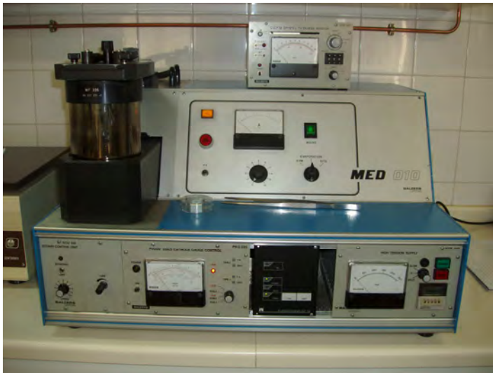
Equipo para tratar con microcapa de carbono
