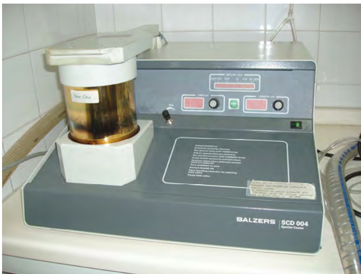
Equipo para tratar con microcapa de oro
