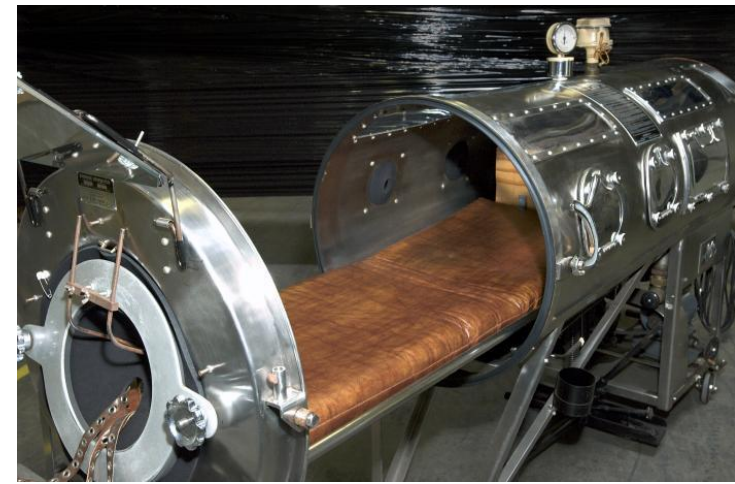
Figura 2. Modelo de pulmón de acero de Emerson. Foto sin derechos de autor. Procedente de: CDC/GHO/Mary Hilpertshauer – número de identificación #6536 .
